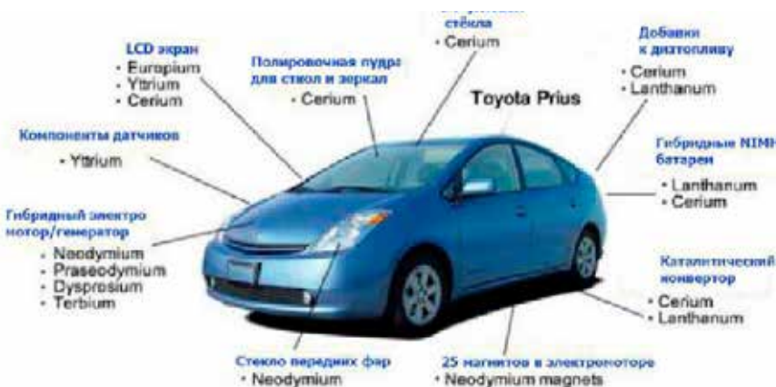
Рис. 2. Узлы в автомобиле, содержащие РЗМ
