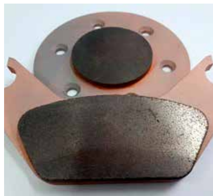
Рис. 2. Отечественные колодки стояночного тормоза автомобилей БЕЛАЗ, заменившие импортную продукцию
