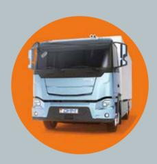
В ОАО «МАЗ» создан экспериментальный образец электрогрузовика МАЗ-4381EE с применением разработанных и изготовленных Объединенным институтом машиностроения НАН Беларуси компонентов силовой установки и деталей экстерьера электромо-
