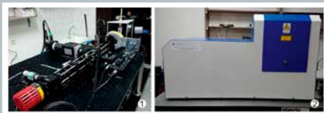
Общий вид аппаратно-программного комплекса лазерно-оптического сканирования для автоматизированной баллистической идентификационной системы: 1 – со снятым корпусом, 2 – в корпусе
