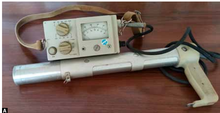
Рис. 1. А – Радиометр СРП-68-01, Б – Проведение прижизненной дозиметрии животных радиометром «Советник»
