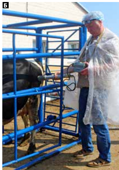
Рис. 1. А – Радиометр СРП-68-01, Б – Проведение прижизненной дозиметрии животных радиометром «Советник»
