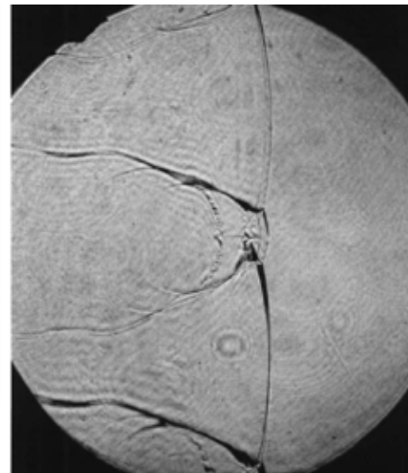
Рис. 2. А) условная схема структуры реальной многофронтной детонационной волны (распространяется слева направо): 1 – головная ударная волна, 2 – зона реакции, 3 – «тройные» точки, 4 – поперечные волны, \lambda – поперечный размер детонационной ячейки, ромбовидные структуры – траектории (во времени) движения тройных точек; Б) теньевые (шлирен) фотографии детонации в смесях ацетилен-кислород-аргон. Иллюстрация из «Austin, Joanna Maria Karol (2003). The Role of Instability in Gaseous Detonation. Dissertation (Ph.D.). California Institute of Technology»
