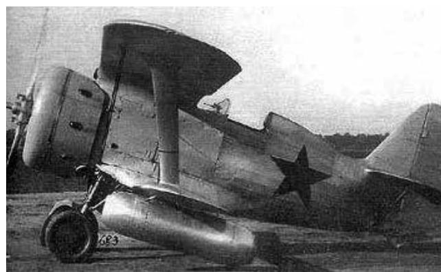
Рис. 1. Инженер И.А. Меркулов (1913–1991) и фотография первой ракеты, использующей ЛФРД. Самолет И-153 для проведения летных испытаний с двумя установленными ЛФРД ДМ-2 диаметром 400 мм
