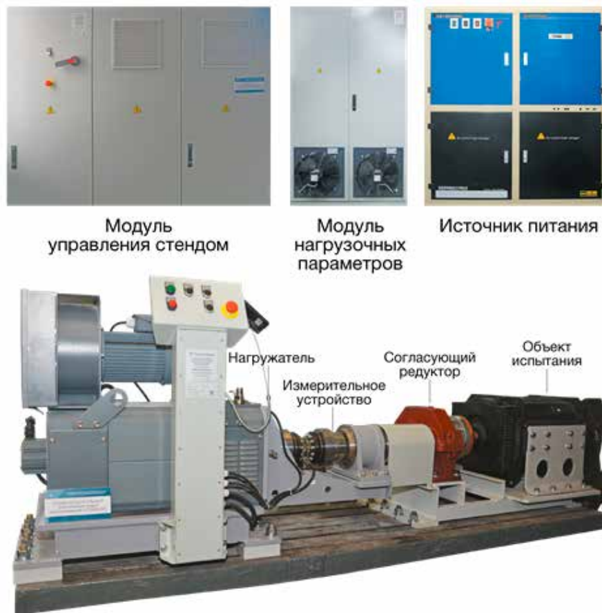
Рис. 6. Общий вид стенда испытаний тяговых электроприводов мощностью до 200 кВт
