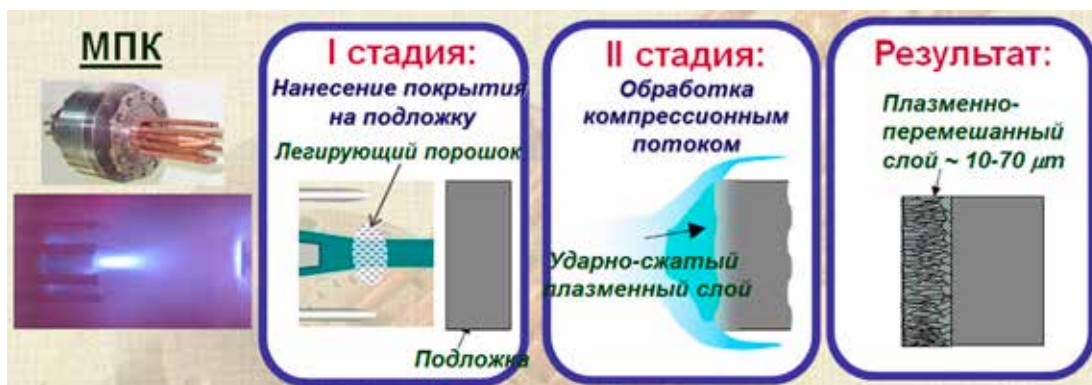
Рис. 3. Принципы поверхностной плазменной металлургии
