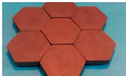
Рис. 2. Прототипы бронезащиты из карбида кремния, созданные в ИТМО имени А.В. Лыкова
