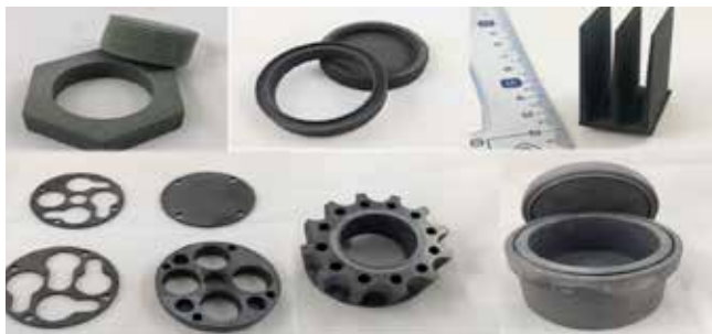
Рис. 5. Образцы изделий сложной геометрии из карбидокремниевой керамики, изготовленные по технологии ИТМО
