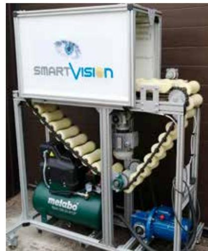
Рис. 9. Макетный образец автоматической сортировальной машины
