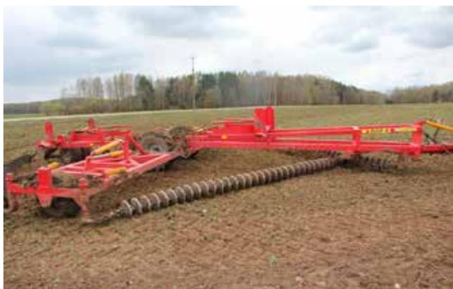
Рис. 10. Дисковый лущильник с шириной захвата 9 м ЛДР-9
