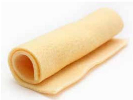
Волокнистый ионит в виде нетканого иглопробивного полотна
