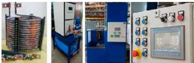
Рис. 6. Оборудование для высокоскоростного индукционного нагрева
