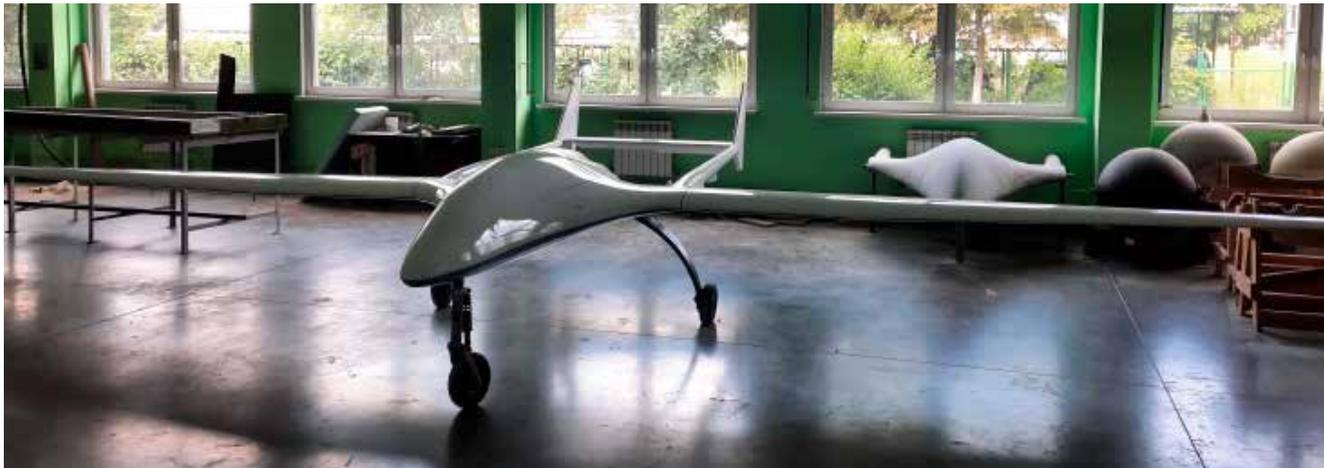
Рис. 12. Новый БЛА «Буревестник 9» с размахом крыла 9 м
