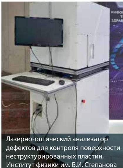
Лазерно-оптический анализатор дефектов для контроля поверхности неструктурированных пластин, Институт физики им. Б.И. Степанова
