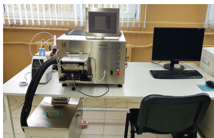
Абсортометр в комплекте с гидравлическим прессом для сжатия образца Absorptometer C
