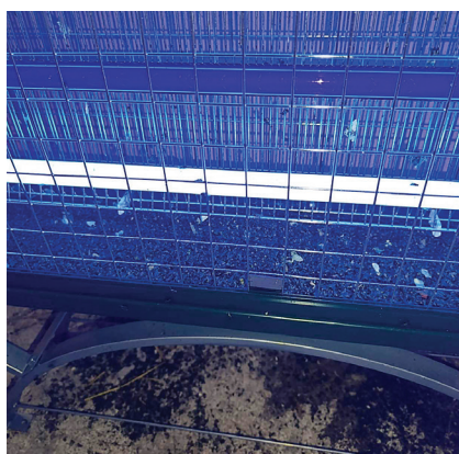
Рис. 4. Лампа-ловушка FROJER XC 60 FSL стационарной установки в производственных условиях со скоплением уничтоженных мух (21-е сутки)
