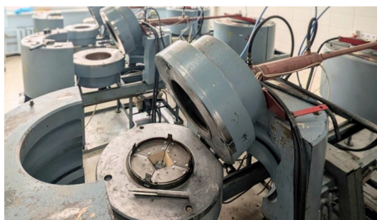
Установки типа «БАРС» (беспрессовые аппараты «разрезная сфера»). Изменение физических характеристик алмаза
