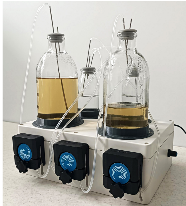
Рис. 1. Автоматический перфузируемый биореактор для фармакокинетического моделирования
