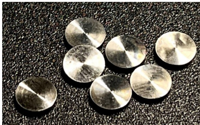
Рис. 3. Титановые диски с образцами пленочных композиционных антибактериальных покрытий для тестирования в биореакторе
