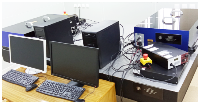
Рис. 6. Опытный образец установки высокой точности для измерений коэффициентов отражения и оптических потерь высокоотражающих оптических элементов лазерных систем
